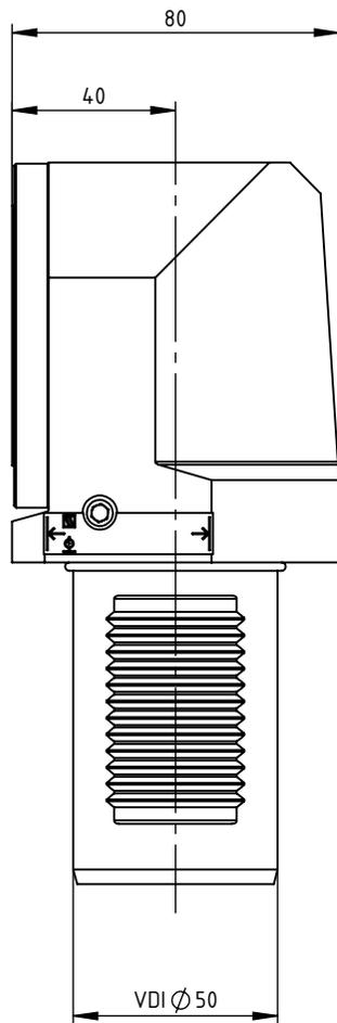
Zum Spannen von Werkzeugen wird ein Zugbolzen benötigt
