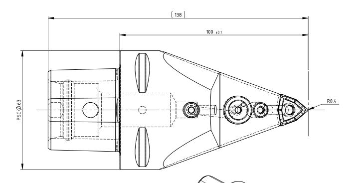
High Pressure (HP). Kühldüse seperat erhältlich. Coolant nozzles separately available. Part Nr.: CHP-PCX.000.022
