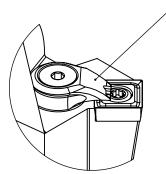
High Pressure (HP). Kühldüse seperat erhältlich. Coolant nozzles separately available. Part Nr.: CHP-PCX.000.022
