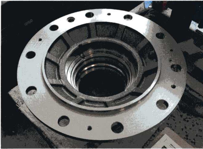
2 Um ein solches Radlager fertigzustellen, werden am Schmiedeguss-Rohteil aus hochvergütetem Stahl unter anderem Außen- und Innendurchmesser auf Maß bearbeitet, Schmiernuten gefräst und Befestigungsbohrungen erzeugt (© Swisstools)
